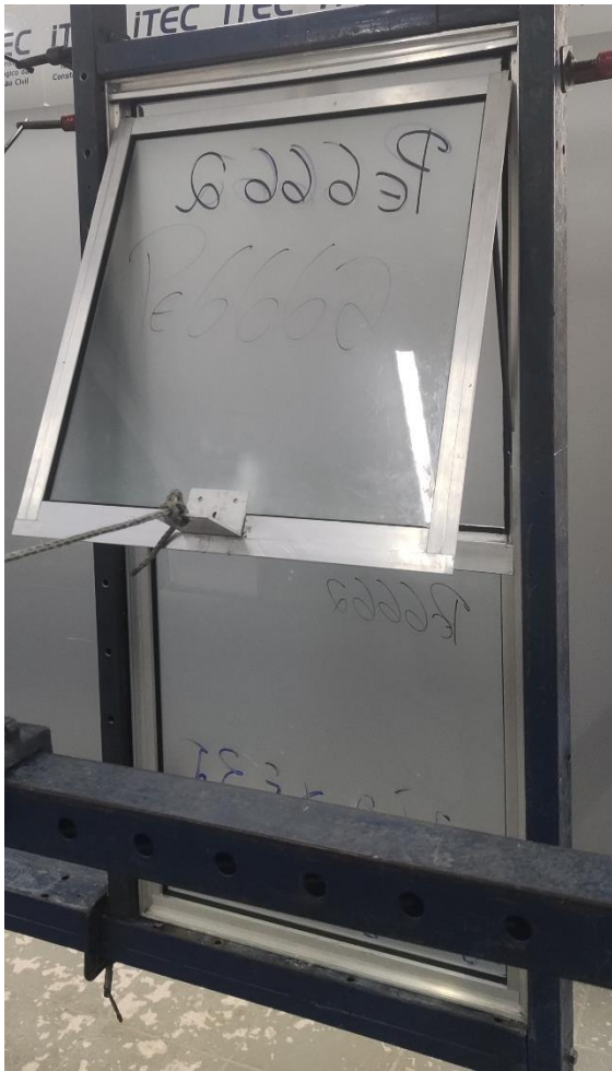
Foto nº. 05 Ensaio de resistência a flexão, do lado interno para o externo.
