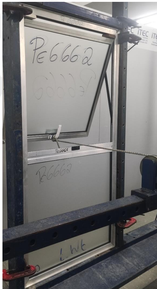
Foto nº. 06 Ensaio de resistência a flexão, do lado externo para o interno.
