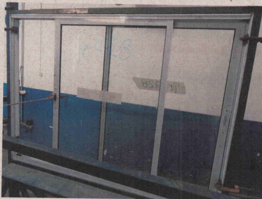
Foto nº. 09. Ensaio de resistência a flexão, do lado externo para o interno.
