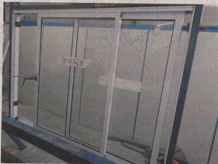
Foto nº. 10 Ensaio de resistência a flexão, do lado interno para o externo.
