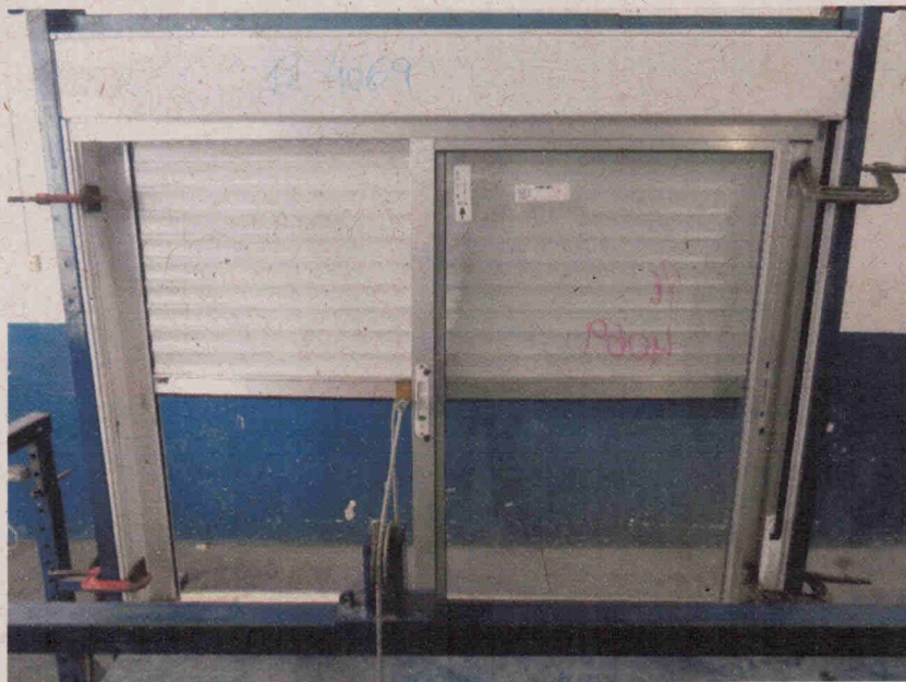
Foto nº. 09 Ensaio de resistência a flexão, do lado externo para o interno: Aplicação na persiana de enrolar.
