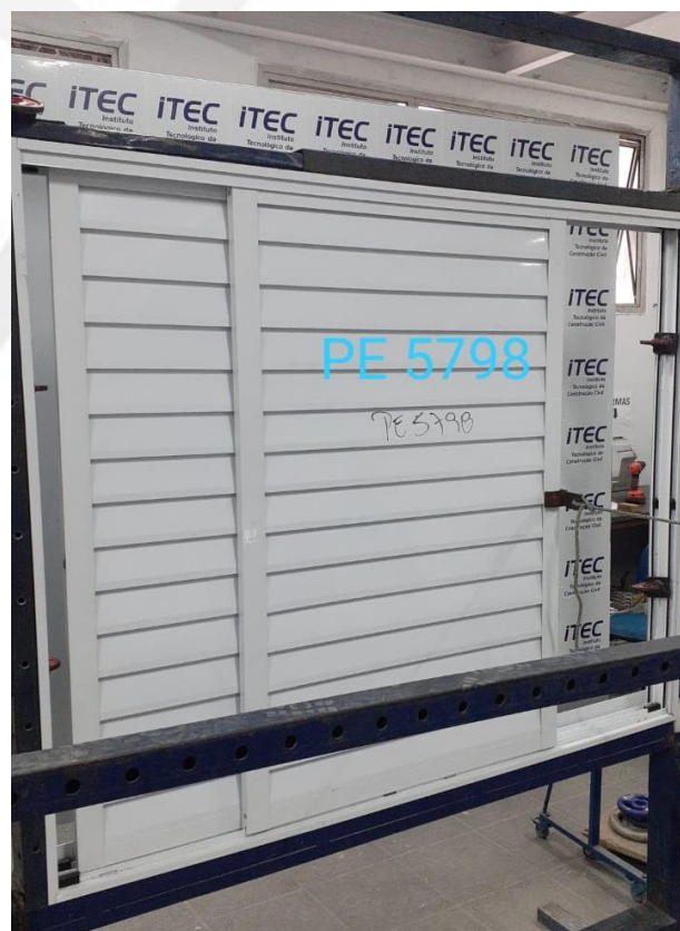
Foto nº. 12 Ensaio de resistência a flexão, do lado interno para o externo.
