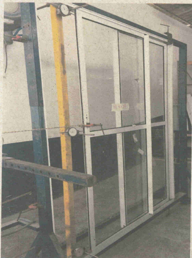
Foto nº. 05 Ensaio de resistência ao esforço horizontal, com um canto imobilizado.
