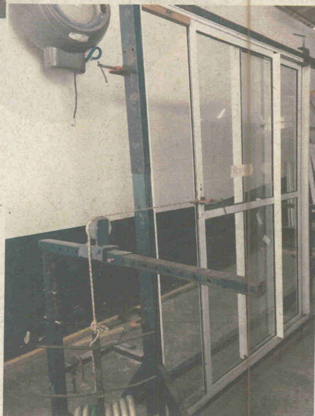
Foto nº. 06 Ensaio de resistência ao esforço horizontal, com dois cantos imobilizados.
