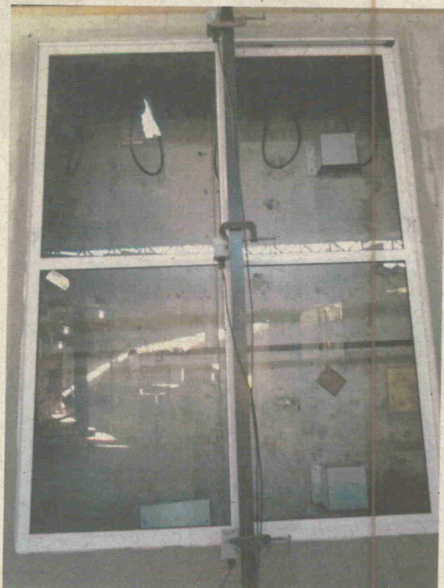
Foto nº. 03 Verificação da estanqueidade à água: PE-02: Transbordamento para a face interna (2').
