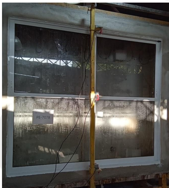
Foto nº. 02 Verificação do comportamento sob cargas uniformemente distribuídas: Posicionamento dos deflectômetros
