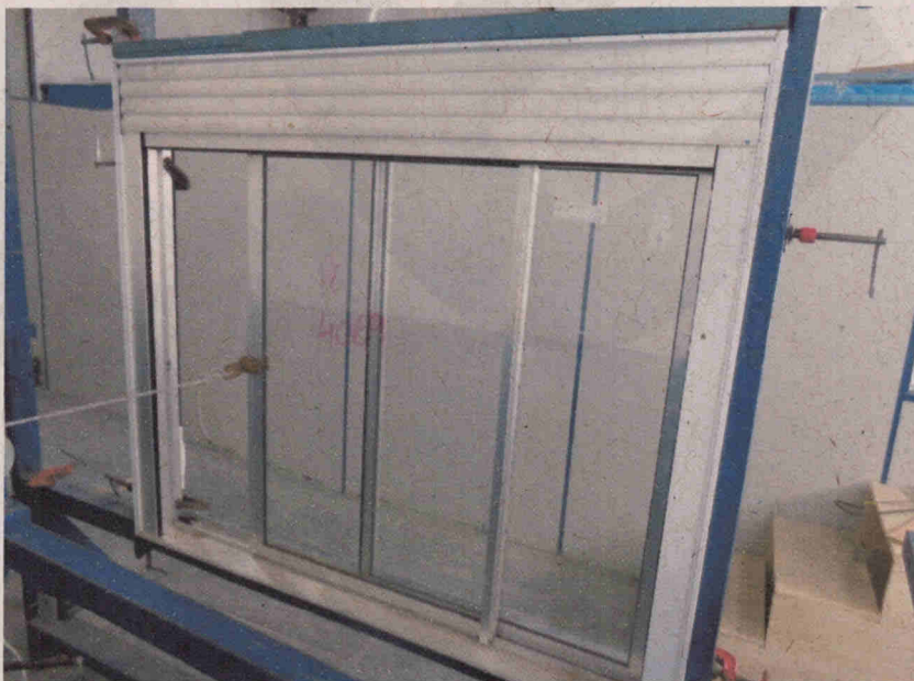
Foto nº. 10 Ensaio de resistência a flexão, do lado interno para o externo: Aplicação na folha de correr.
